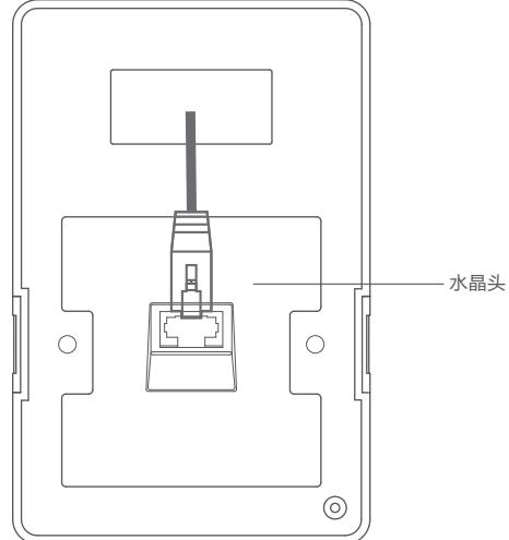
3 对准设备与暗盒上的螺丝孔，装入螺钉以固定，请勿将螺钉拧得过紧。
