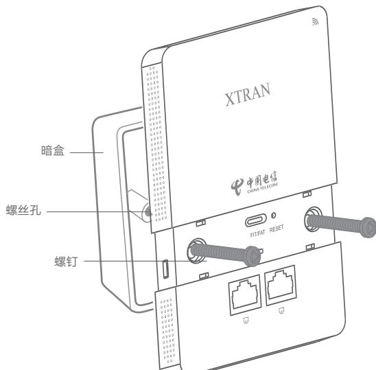
4 根据图示方向固定壳盖，完成安装。
